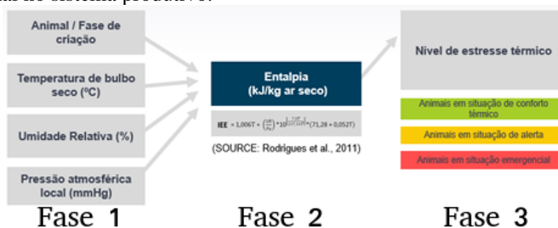
Figura 1. Diagrama de processamento para o diagnóstico do conforto térmico
